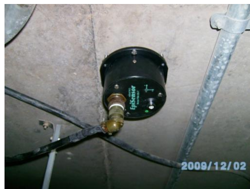
圖 4 本系統丹鳳站加速度強震儀
