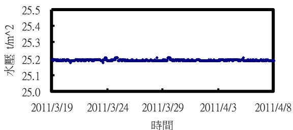
圖 9 電子式水壓計監測結果
